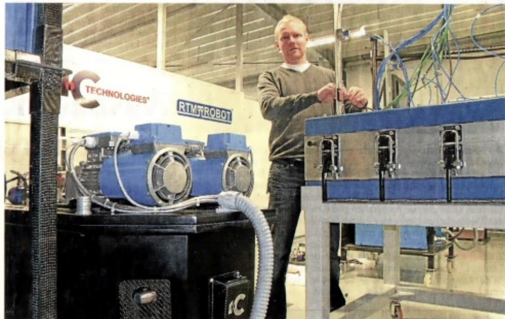
Gesellschafter Dirk Krämer montiert einen Schlauch an der weltweit einzigartigen Produktionsanlage. Links steht der Harzinjektor, rechts ist die Form für die Verbundfaserbauteile zu sehen.
